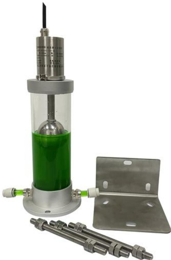
静力水准仪所采用的磁致伸缩式传感器具有分辨率高、稳定性好、性能可靠、响应速度快、工作寿命长、线性测量、绝对量输出、非接触测量、永不磨损，输出信号多种选择：RS485、电压、电流等标准量，安装简单方便等性能。
