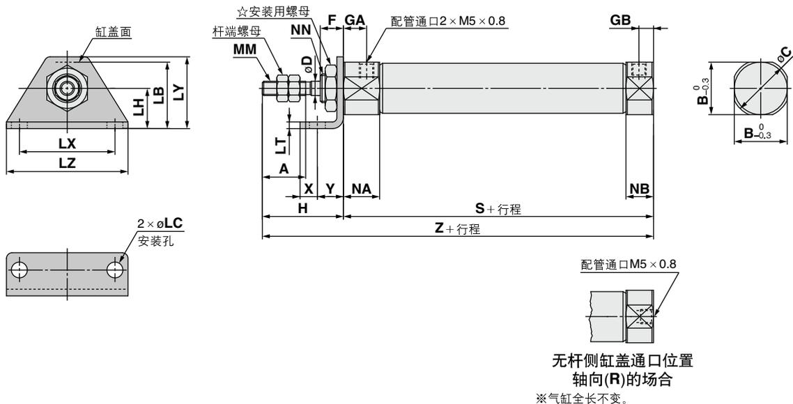
带气缓冲:CJ2L 缸径 - 行程 A 无杆侧缸盖的通气位置 Z
