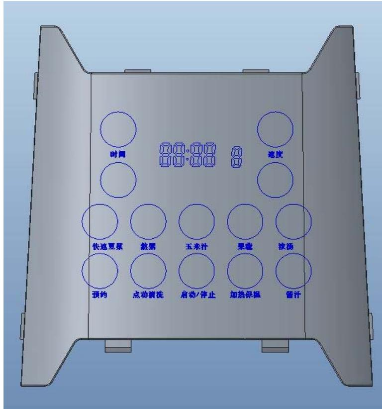
插上电源，放好水杯后，所有指示灯亮 2 秒，蜂鸣器长鸣 2 秒。功能面板指示灯亮白色，时间显示白色 88: 88，速度显示白色 8.
