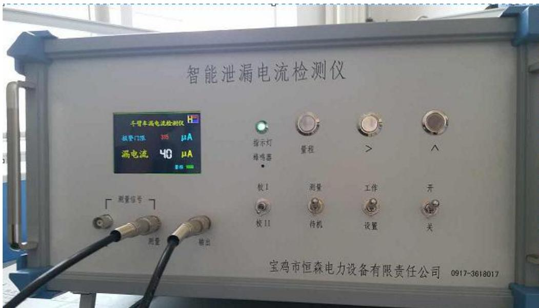
智能泄漏电流检测仪前面板图
