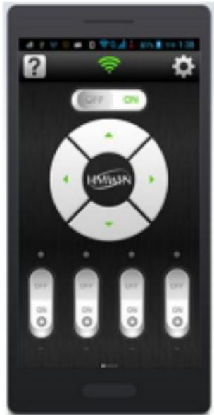
第6步： 如果连接成功，就可以进行对码动作，对码，灯具上电3秒内，按一下16组灯光的任意一组的 "on"，对码成功灯具白光闪烁3下
